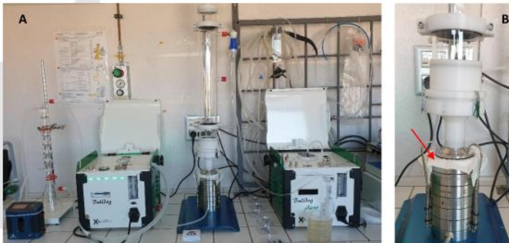
Figura 2 – A) Sistema per l'esecuzione del test. B) Particolare del campionatore multistadio con un provino inserito (freccia)
